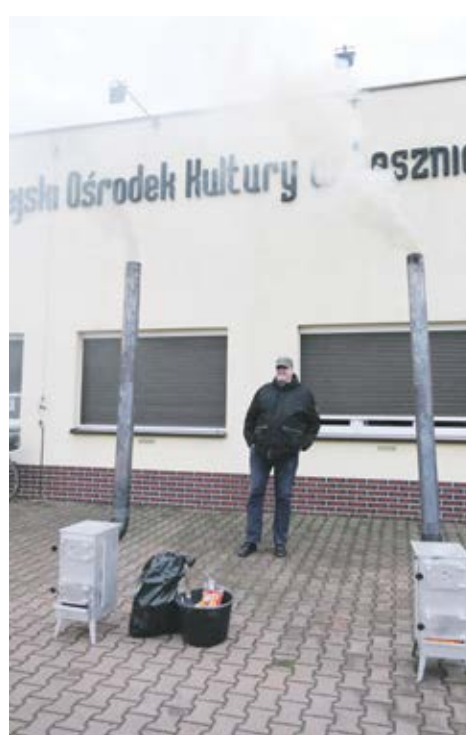
Palenie metodą od góry (po lewej) i od dołu (po prawej) pokazuje, że emisja dymu jest o wiele większa w przypadku klasycznego rozwiązania.
