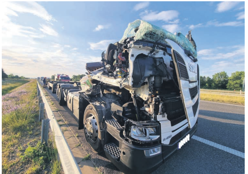
Zdjęcie: Michał Hoffmann, OSP Izbice // W wyniku uderzenia kabina scania została rozerwana, naczepa drugiego pojazdu przetrwała zderzenie
